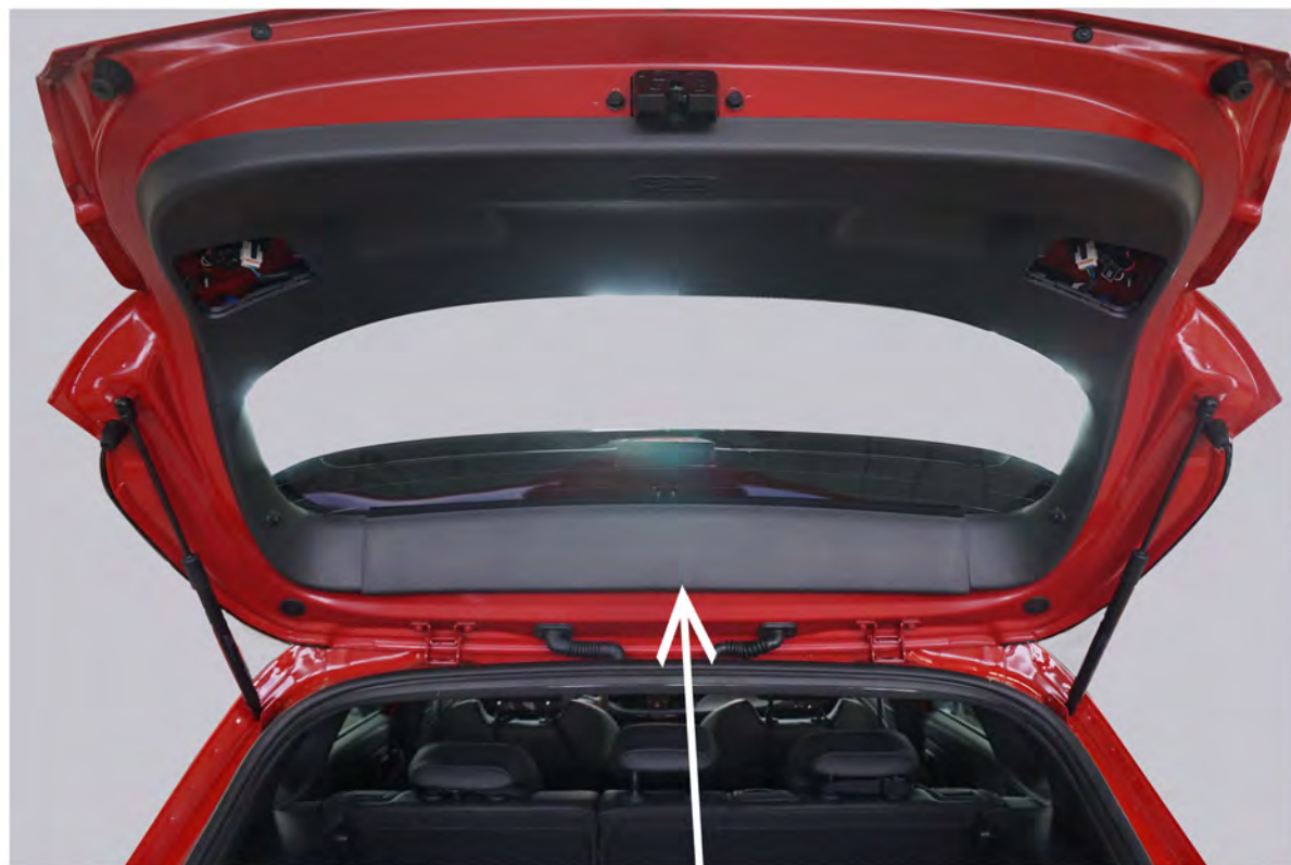
Mittlere Verkleidung ausbauen.
