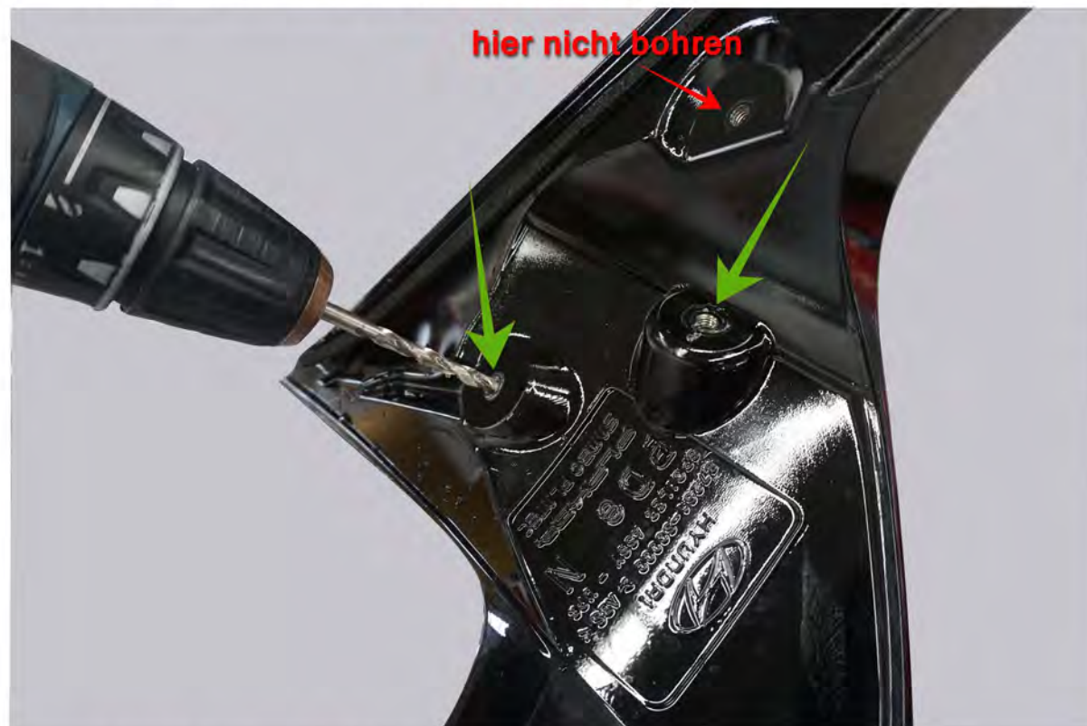
Die beiden Bohrungen erst mit einem 5,5mm vorbohren . ACHTUNG!!!! darauf achten das die Gewindemutter nicht überhitzt und somit die Kunststofffassung schmilzt! Langsam und auf Etappen bohren. danach mit einem 6,5mm Bohrer komplett durchbohren und die Mutter als Führung verwenden um die Aussenhaut durchzubohren. Bohrer gerade in Achse mit der Gewindemutter halten!
